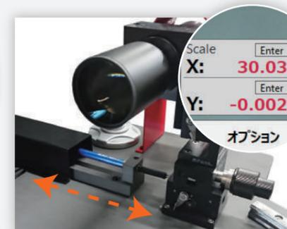
USBゲージでのY方向座標測定
