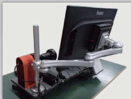
PCを標準で付属し、モニターと一体で装置本体に組み付ける事で省スペース化を図っています。
